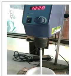
Dihomogenizer kecepatan 1200 rpm
