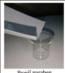
Propil paraben dilarutkan pada etanol 96%
