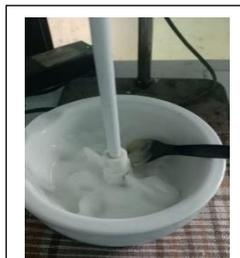
Dihomogenizer kecepatan 1000 rpm
