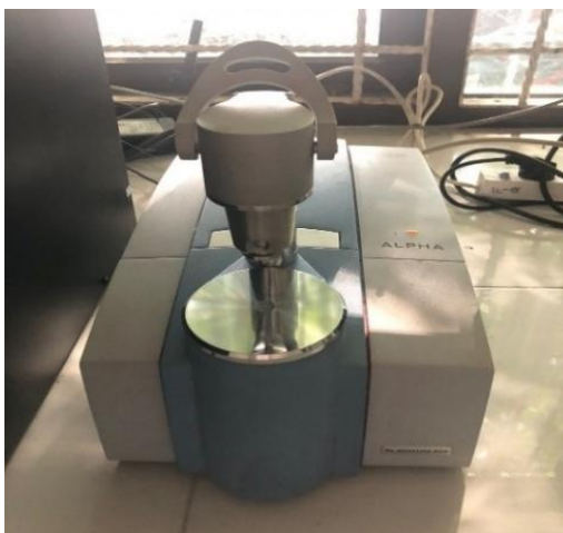
Gambar 2.6 Spektroskopi Inframerah (Dokumentasi Pribadi., 2024)
