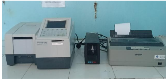
Gambar 2. 6 Alat spektrofotometri uv-vis
