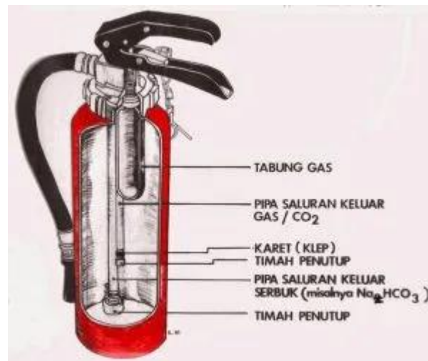
Gambar 4 Bagian APAR jenis cartridge system
