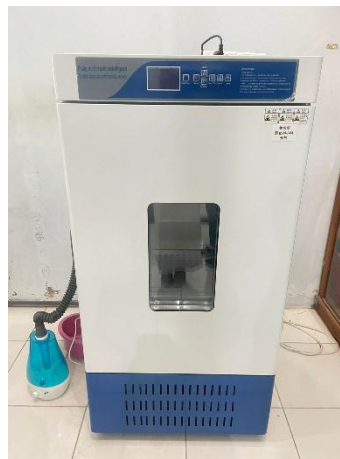
Gambar 2.3 Alat Climatic Chamber (Dokumentasi Pribadi)
