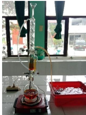
Gambar 2.3 Ekstraksi Soxhletasi (Dokumen Pribadi, 2025)
